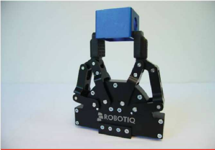
La Main Robotiq à deux doigts qui a été lancée sur le marché cet été et dont bien peu d'entreprises en ont entendu parler.
