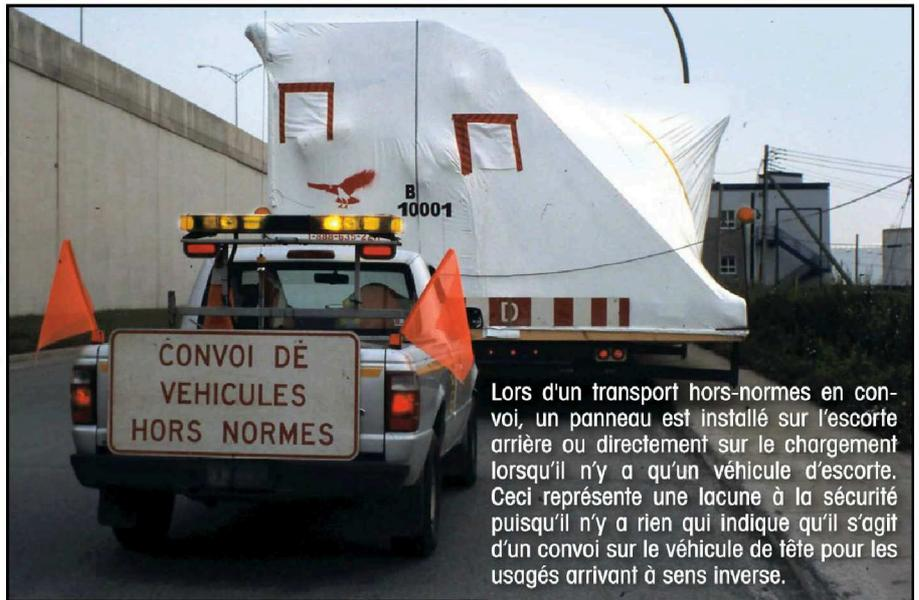
Lors d'un transport hors-normes en convoi, un panneau est installé sur l'escorte arrière ou directement sur le chargement lorsqu'il n'y a qu'un véhicule d'escorte. Ceci représente une lacune à la sécurité puisqu'il n'y a rien qui indique qu'il s'agit d'un convoi sur le véhicule de tête pour les usagés arrivant à sens inverse.
