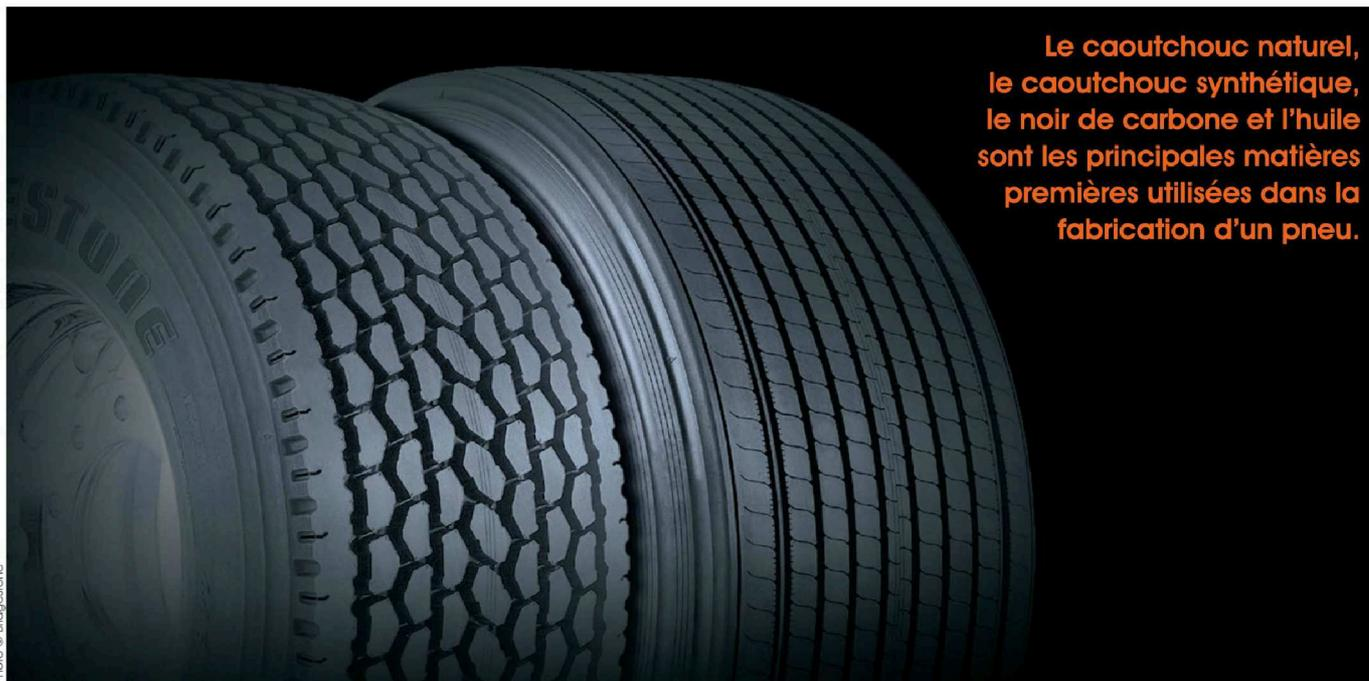
**Le caoutchouc naturel, le caoutchouc synthétique, le noir de carbone et l'huile sont les principales matières premières utilisées dans la fabrication d'un pneu.**
